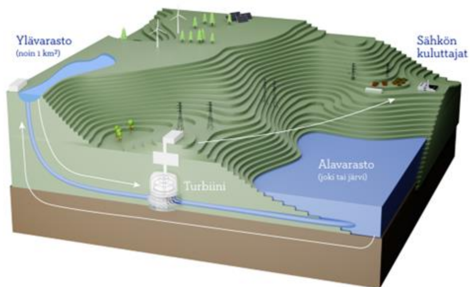
Kuva 3-1-1. Yleispiirteinen kuva pumppuvoimalaitoksen toimintaperiaatteesta.
